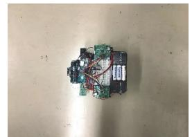
右側のモーターだけ回転するようにプログラムした。車体が一回転した時の車輪の回転数を調べた。この実験では1回転は目で追うことができるが細かい回転数を測ることができないので目で追った回転数 $+ \theta / 360$ であらわすことにした。 $\theta$ の部分は写真に収め分度器で測った。
